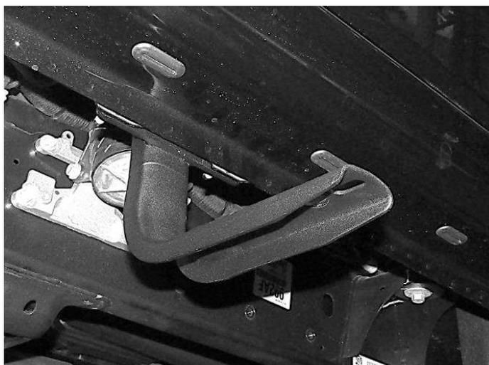
3. Repita las mismas operaciones del paso anterior para instalar el bracket central y trasero.
