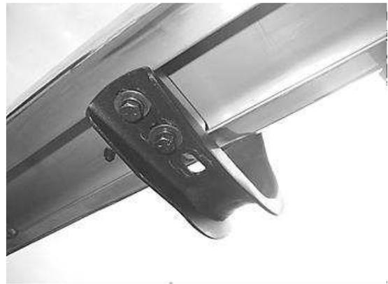
5. Si instala estribos Fusion y Platinum, coloque el estribo sobre los brackets e introduzca un canal "U" (incluidos en el estribo) por cada bracket. Asegure el bracket al canal "U" utilizando (2) rondanas planas 5/16", (2) rondana de presión 5/16" y (2) tuerca hex 5/16". Imagen 6. Alineé el estribo y apriete toda la tornillería.
