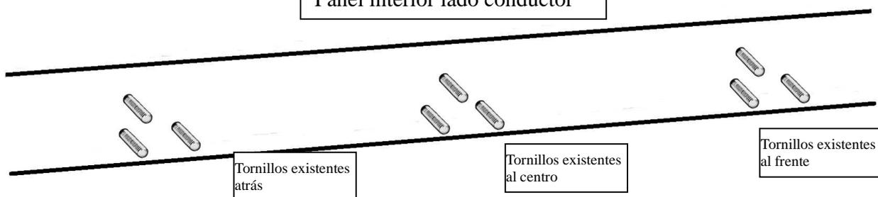
2. Instale uno de los brackets en el frente del vehículo colocándolo en los (3) tornillos existentes y asegurándolo con (3) rondanas planas G. Azul, (3) rondanas de presión G. Azul y (3) tuercas hex M8 G. Azul. No apriete aún. Imagen 3. **Nota:** Los tornillos inferiores del panel podrían tener un exceso de pintura en las cuerdas. Se recomienda atornillar la tuerca antes de colocar el bracket para eliminar un poco de la pintura.
