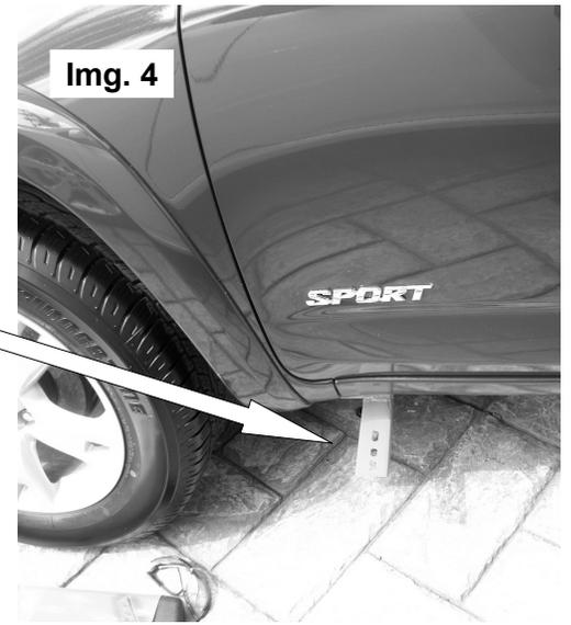
5. Instale el bracket trasero lado conductor; removiendo el tornillo del fajo que sujeta el tanque de la gasolina img.5. Coloque el bracket con su tornillo con solera de 1/2" y fíjelo al chasis de la camioneta, la parte posterior del bracket debe fijarse con el mismo tornillo del fajo de tanque. Colocando el bracket sobre el fajo del tanque de gasolina. img. 5
