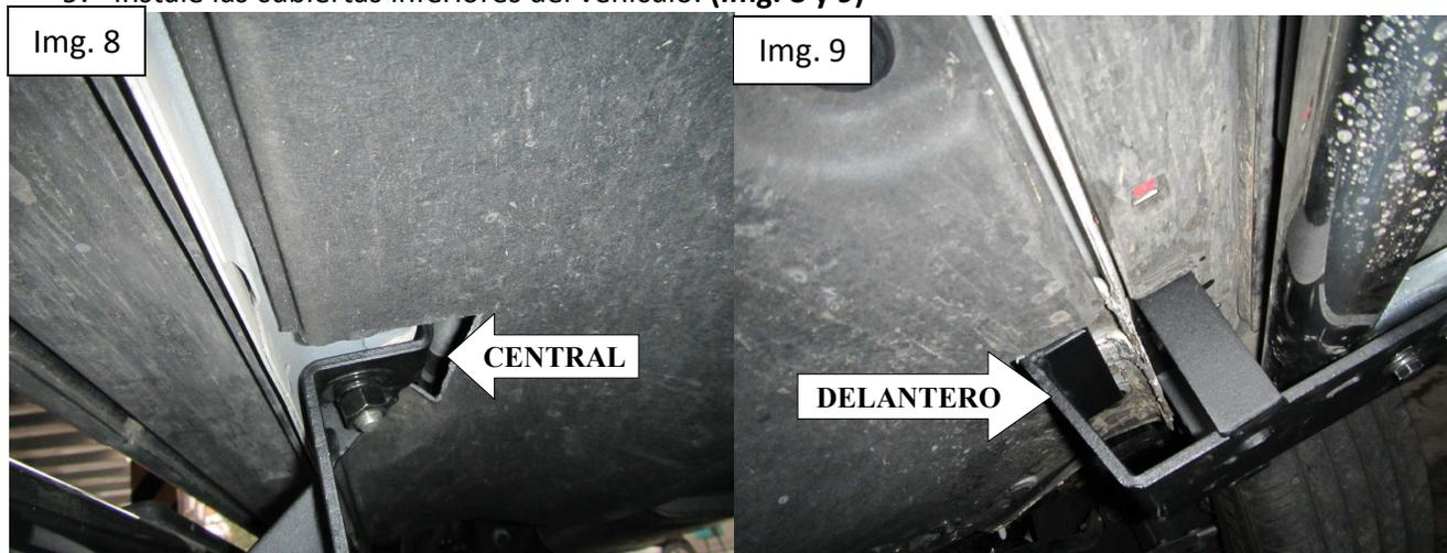
10. Instale el estribo utilizando los tornillos y brackets que vienen en la caja de estribos.
