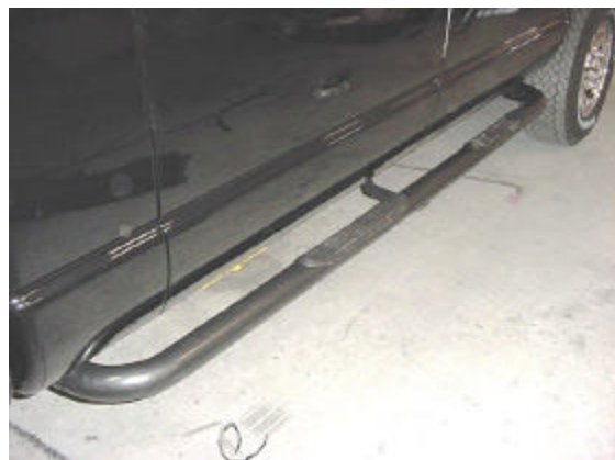
SIDE BAR INSTALADO. FOTO LADO CONDUCTOR.
