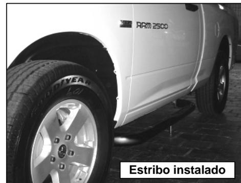
9. Haga cualquier ajuste final a la alineación del estribo y apriete toda la tornillería, comenzando por los brackets. Repita todos los pasos descritos anteriormente para instalar el lado contrario.
