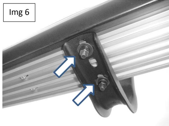
9. Para estribos Wide Sider 4" / 5" / 6" coloque los brackets de estribo en la parte interior del estribo y fíjelos al bracket utilizando dos tornillo 5/16"x1", dos rondanas planas 5/16" y dos rondanas de presión 5/16" para cada bracket. **(Img 7)**
