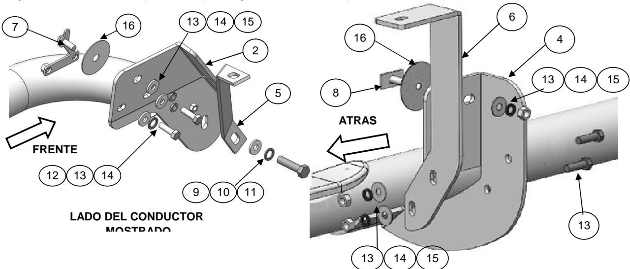
5. A continuación coloque (1) bracket delantero y fíjelo al tornillo de la placa que colocó en el panel del vehículo con: (1) rondanas plana y de presión 3/8", (1) tuerca hex. 3/8". Y a las tuercas de la placa con (2) Tornillo cab. hex 3/8 x 1 1/4", (2) rondanas plana y de presión 3/8". Foto 2. No apriete aún. Repita la operación para el bracket medio.
