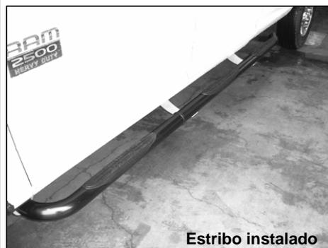
10. Haga cualquier ajuste final a la alineación del estribo y apriete toda la tornillería, comenzando por los brackets. Repita todos los pasos descritos anteriormente para instalar el lado contrario.
