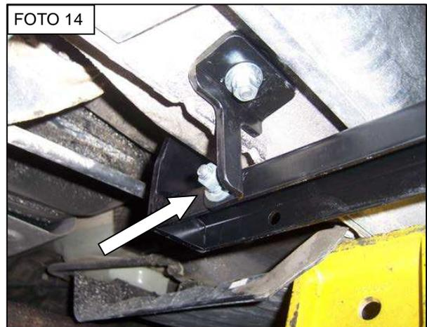
11. Ajuste el lado del conductor, en la parte superior de los brackets y ajustar el estribo con el vehículo. Coloque los soportes de sujeción en el interior de la abertura de la barra lateral y alinee las roscas de fijación del soporte con los orificios de ranura en los brackets. Coloque el estribo con cada uno de los brackets y con el bracket de sujeción, utilizando ( 2 ) tornillo 5/16 x 1" cab. Cuadrada, rondana plana, rondana de presión de 5/16". No apriete aún. **Foto 15.**
