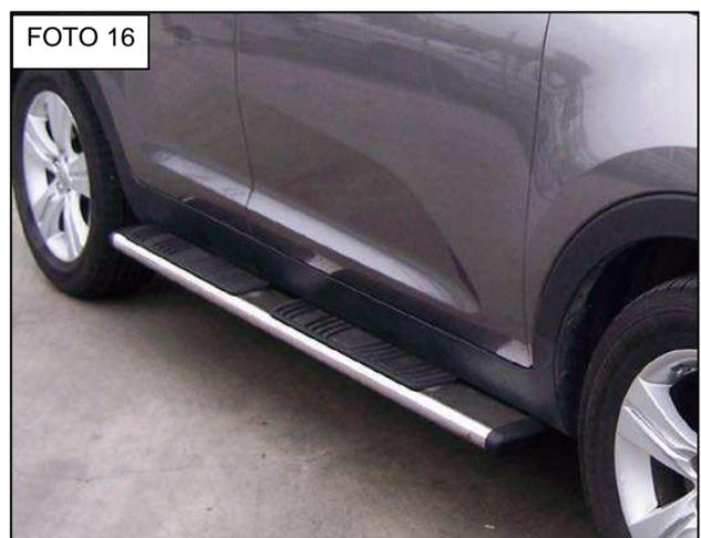
12. Vuelva a alinear los estribos con el vehículo y apriete toda la tornillería.
