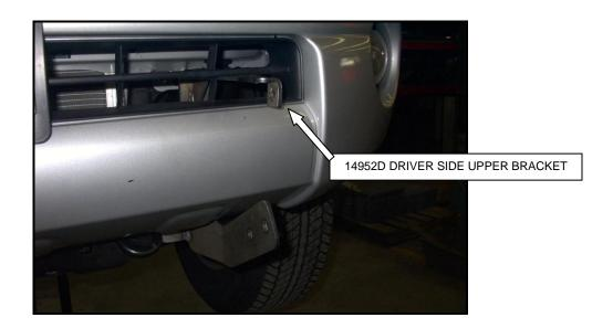
**STEP -5** POSITION 14952D UPPER BRACKET BEHIND THE BUMPER, AND OUT THROUGH THE GRILLE OPENING AS SHOWN.
