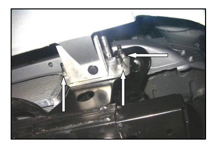
**STEP -1** BEGINNING WITH THE DRIVER SIDE, LOCATE THE STUDS AND HEX NUTS THAT SECURE THE BUMPER BRACKET TO THE FRAME. REMOVE (3) HEX NUTS AT THE LOCATIONS SHOWN.
