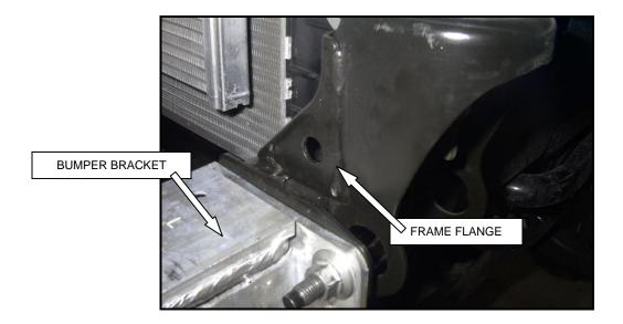
**STEP -4** LOCATE THE HOLE IN THE FRAME FLANGE ABOVE THE BUMPER BRACKET.
