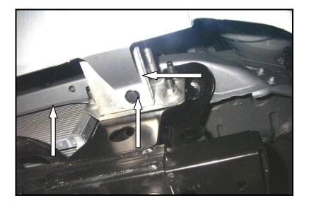
**STEP -1** BEGINNING WITH THE DRIVER SIDE, LOCATE THE STUDS AND HEX NUTS THAT SECURE THE BUMPER BRACKET TO THE FRAME. REMOVE (3) HEX NUTS AT THE LOCATIONS SHOWN.
