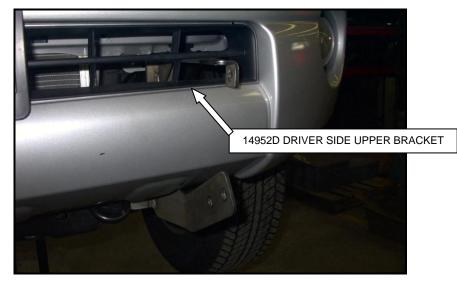
STEP- 5 POSITION 14952D UPPER BRACKET BEHIND THE BUMPER, AND OUT THROUGH THE GRILLE OPENING AS SHOWN.
