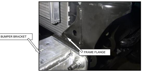
STEP- 4 LOCATE THE HOLE IN THE FRAME FLANGE ABOVE THE BUMPER BRACKET.
