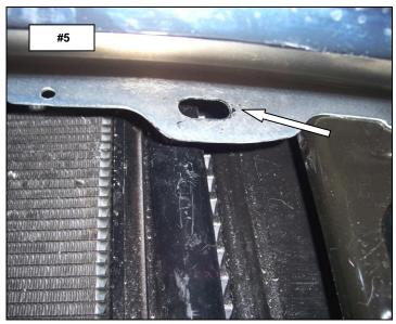
**STEP-5** POSITION ONE OF THE UPPER BRACKETS THROUGH THE OPENING AND BEHIND THE BUMPER, SO THE LONGER LEG OF THE BRACKET EXTENDS OUT BETWEEN THE TOP OF THE BUMPER AND THE BOTTOM OF THE GRILLE. **PHOTOS #6 & #7**
