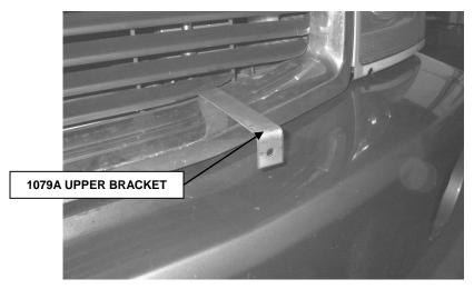
**STEP 7.** POSITION 1079AP UPPER BRACKET IN THE GRILLE AS SHOWN, AND ATTACH TO THE CROSS MEMBER USING THE FACTORY BOLT. REPEAT THE INSTALLATION FOR THE PASSENGER SIDE UPPER MOUNTING BRACKET.
