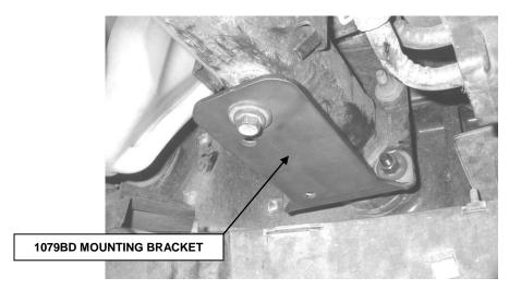
**STEP 2**. POSITION 1079BD LOWER MOUNTING BRACKET OVER THE STUDS, AND LOOSELY ATTACH THE BRACKET TO THE FRAME USING THE FACTORY NUTS AND BOLT AS SHOWN.
