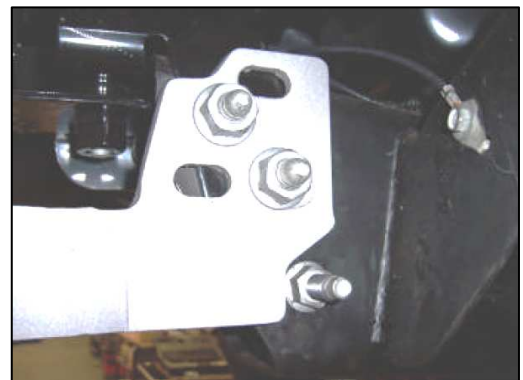
fotografía 1. Muestra la fijación en motor diesel.
