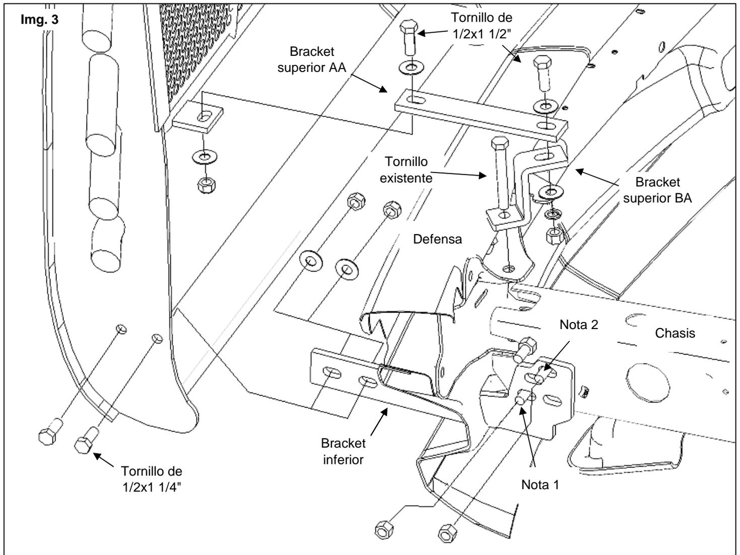
**Nota 1.** Utilice el tornillo existente para fijar el bracket, en el caso que el vehículo no traiga ganchos de arrastre, utilice los tornillos de 1/2x1 1/2" agregados en el kit de tornillos.
